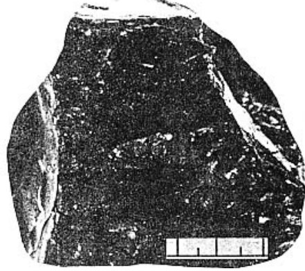
图 A30. 暗淡煤 MDDAAB04 E 2 辽宁沈北 主要由暗煤组成,块状构造,外生裂隙较发育。
