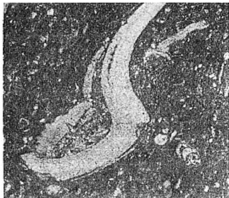
图 A19. 泥晶生物屑灰岩 YSEB22050 (单) ×47 P 2 重庆天府 泥晶生物屑结构,泥晶>亮晶,生物屑主要由三 叶虫、有孔虫、腕足等组成。
