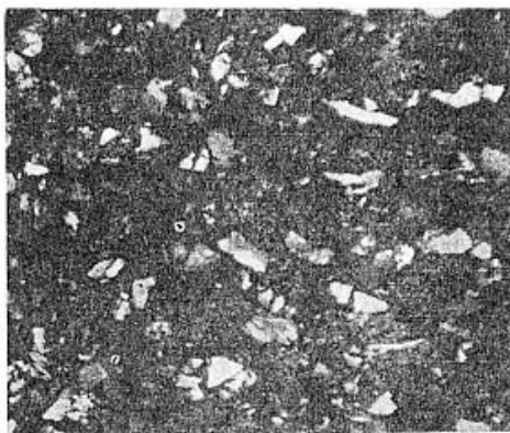
图 A3. 细粒长石砂岩 YSCBAA2019/YSEB20351 (正) ×50 J 1-2 陕西榆神府 细砂状结构,主要由石英、长石组成,含岩屑,分 选中等。
