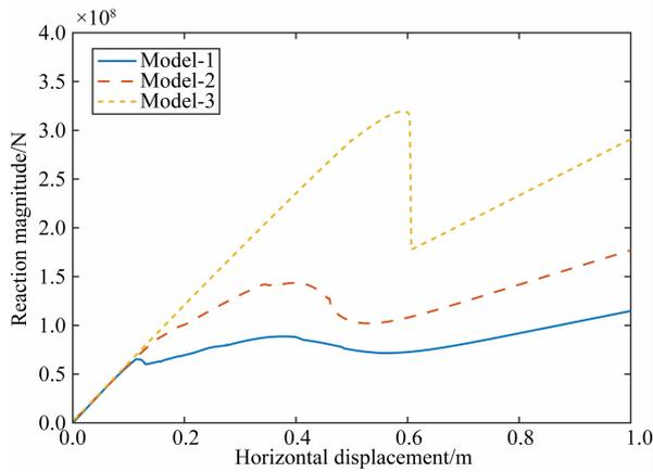
图6 龙门山断裂带深浅部倾角取不同值时的平衡路径曲线
