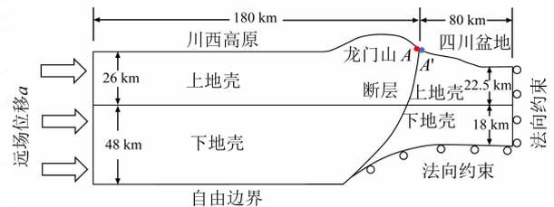
图2 汶川地震不稳定性地震力学模型示意图
