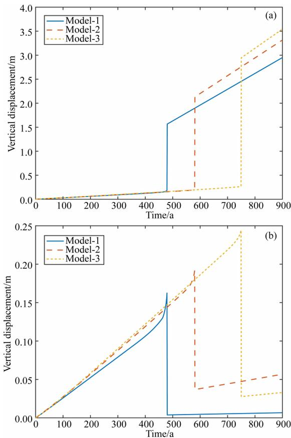
图 8 当地震失稳时龙门山断裂带深浅部倾角取不同值时断层两盘地表处垂直位移随时间的变化
