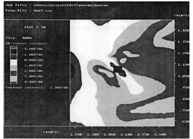
图 3 巷道围岩剪切应力分布云图
