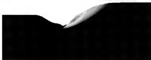
图 12 管线开挖后潜在滑动面示意图(侧视图)
