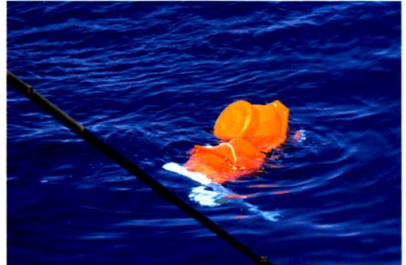
图 1 国产 I-4C 型宽频带 OBS 回收现场照片
