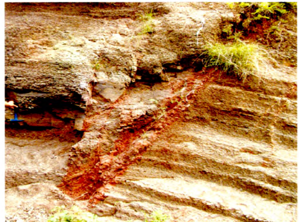
图7 野外地质现象揭示正断层上盘诱导裂缝更发育(发育于山东新汶地区汶南组泥岩中的断裂)
