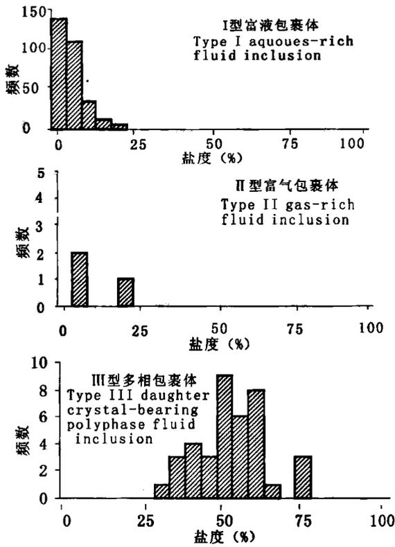
图 5 铜厂斑岩铜矿不同类型流体包裹体盐度直方图
