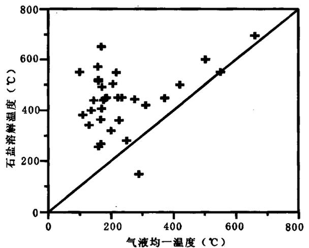
图 9 德兴斑岩铜矿床含石盐多相包裹体气液均一温度与石盐溶解温度相图
