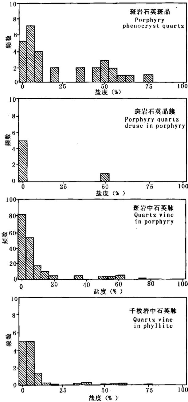
图3 铜厂斑岩铜矿不同产状流体包裹体盐度直方图
