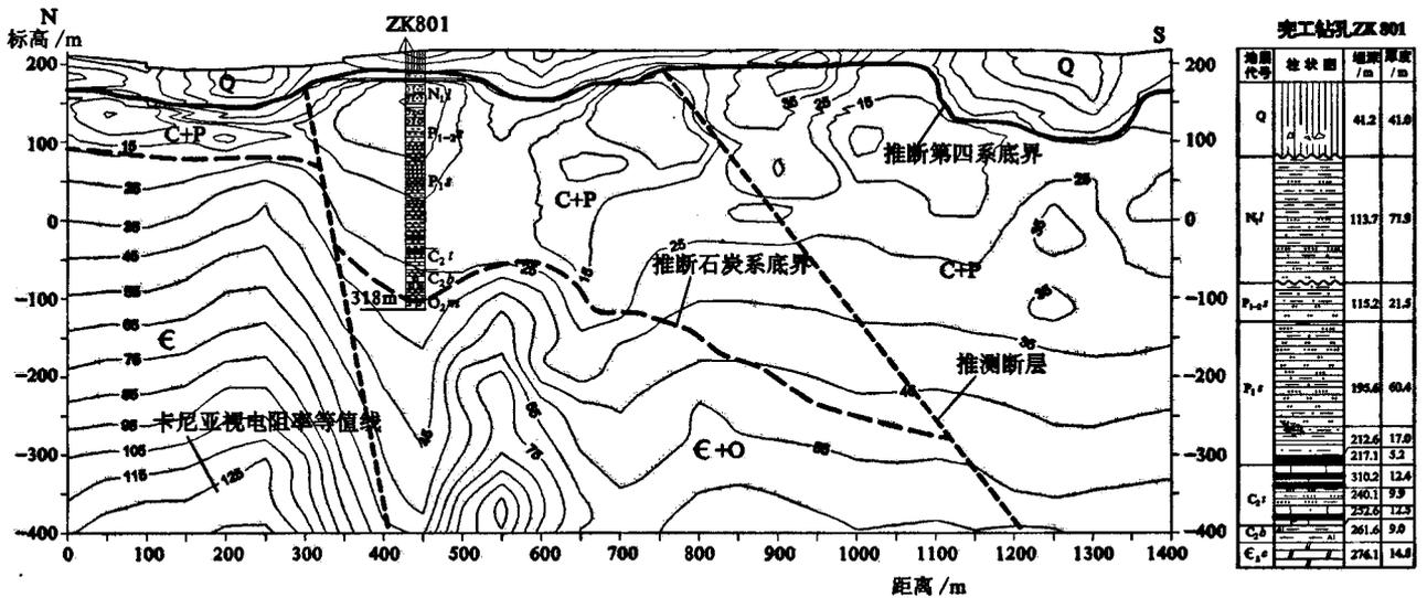
图5 新安郁山煤、铝找矿靶区8勘探线设计剖面与验证钻孔的对比
