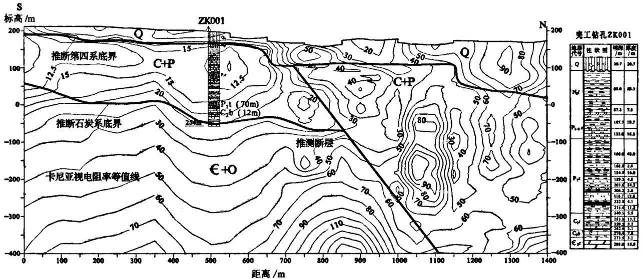
图6 龙门—诸葛一带煤、铝找矿靶区0勘探线设计剖面与验证钻孔的对比(地层代号注释同图5)
