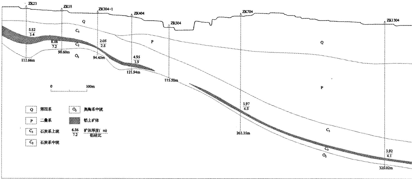
图1 偃师夹沟铝土矿区04勘探线地质剖面
