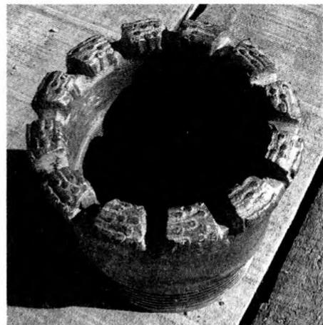
图5 热压孕镶针状合金——金刚石复合胎体钻头的磨损情况
