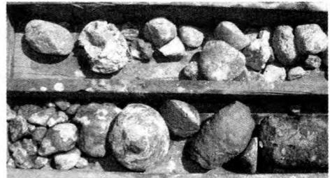
图4 热压针状合金——金刚石复合式钻头取出的部分岩心
