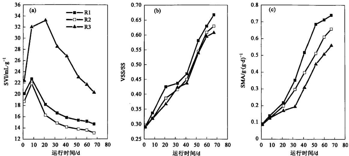
图1 各反应器污泥 SVI、VSS/SS、SMA 变化
