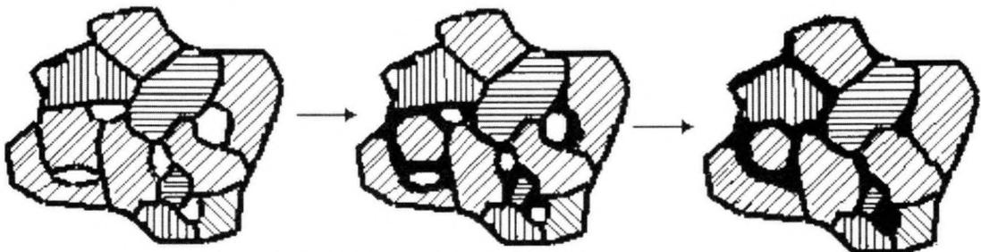
图 6 Mo 颗粒在 Cu 液相中的溶解再析出示意图
