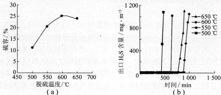
图 2 脱硫温度对脱硫剂穿透硫容的影响及脱硫剂在不同脱硫温度下的穿透曲线
