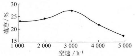
图4 脱硫时空速对穿透硫容的影响
