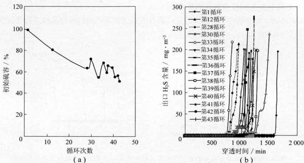
图 6 不同试验进度的穿透硫容及穿透曲线
