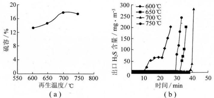
图5 再生温度对穿透硫容的影响及不同再生温度下脱硫剂的穿透曲线
