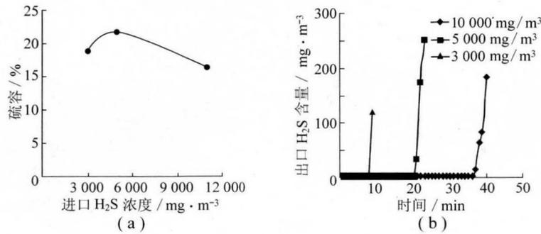
图3 进口H<sub>2</sub>S浓度对穿透硫容的影响及脱硫剂在不同进口H<sub>2</sub>S浓度下的穿透曲线
