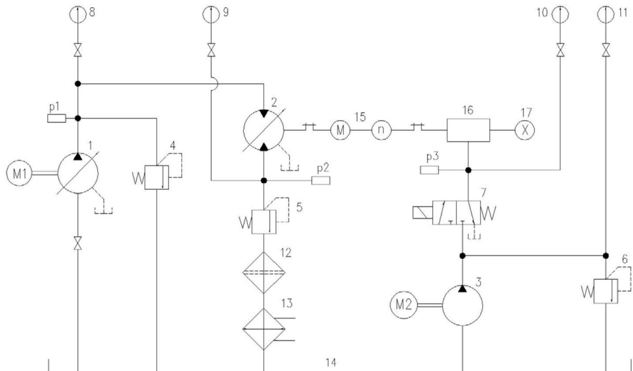
1—变量泵； 2—液压马达； 3—控制油泵； 4—高压溢流阀； 5、6—低压溢流阀；
