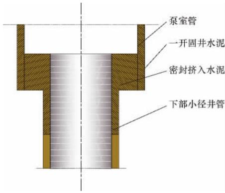
图 2 重叠挤水泥密封(穿袖封固连接)示意
