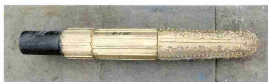
图2 \varnothing 150 mm 开窗铣锥
