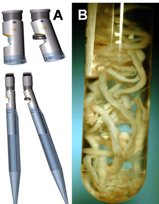
**Figure 5** *Debulking device. Silverhawk™ device (ev3, Paris, France). (A) Système d'athérectomie directionnelle. Avec sa lame rotative (8000 tours/min), ce système permet de couper la plaque d'athérome et de l'emmagasiner dans un sac collecteur. (B) Matériel récolté dans le sac collecteur du Silverhawk™ après plusieurs passages au niveau d'une artère fémorale superficielle diffusément malade.*
