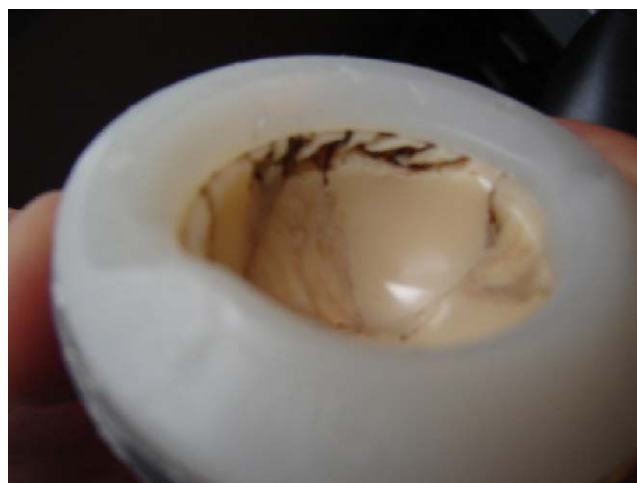
Figure 3 Explant de l'insert retrouvé chez la patiente ayant présenté deux épisodes de luxation. Découverte fortuite de la rupture lors de l'ablation de l'insert pour changement de cotyle pour instabilité.
