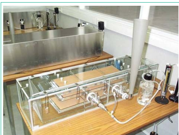
Fig. 1. Chambre d'essai d'émission de COV par les produits de construction – Norme NF EN ISO 16000-9 (crédit photo : CSTB).
