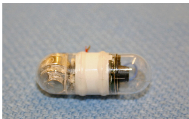
Figura 17 - Wireless Capsule Endoscopy (WCE). En su extremo derecho presenta el sistema óptico, y en el extremo izquierdo el sistema magnético para su guiado. Tomado de 35 .
