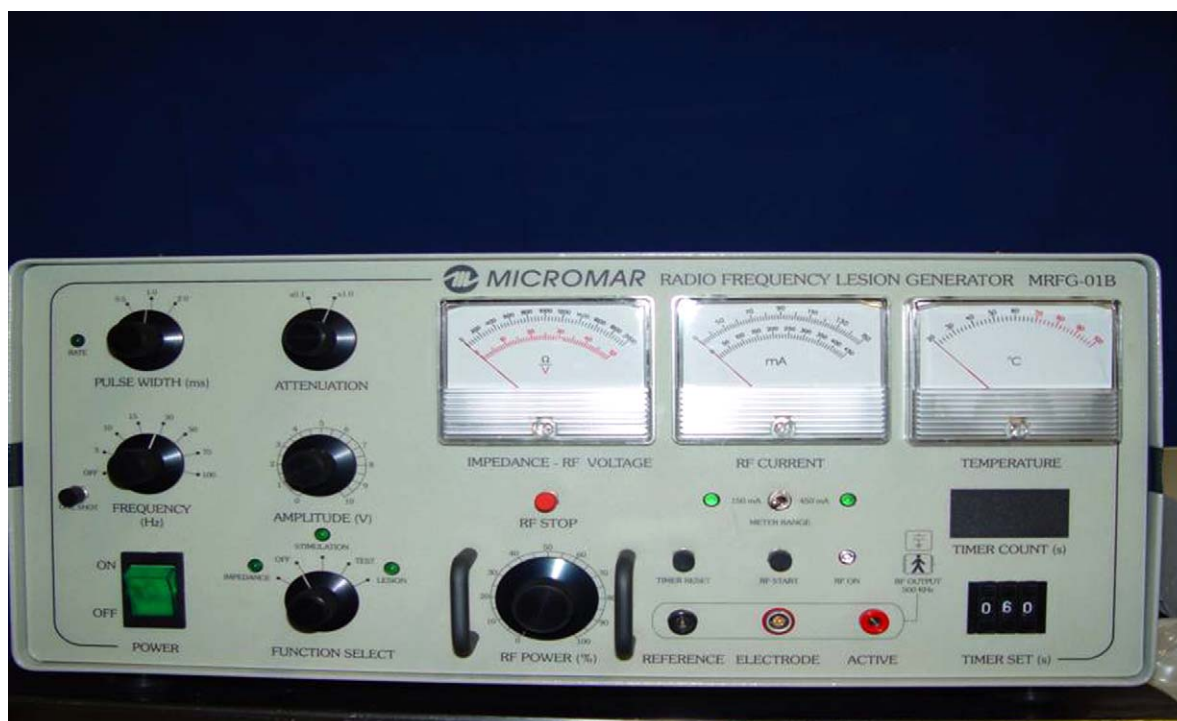
Figura 2 Generador de lesiones por radiofrecuencia (MRFG-01B, MICROMAR, São Paulo, Brasil).
