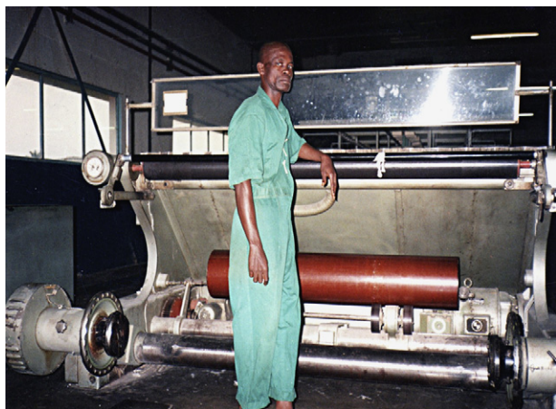
Figure 1. Surveillance et interventions manuelles ou assistées dans les différentes opérations fondamentales de la filature: Mélange & abattage, Epuration, Cardage, Affinage & régularisation, Filage (bobinage et renvidage). Installations vétustes, pièces en mouvements non protégées.
