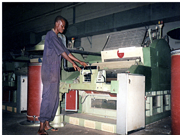
Figure 3. Travail de réglage permanent de la machine (égréneuse-batteuse-presseuse), exigeant une grande concentration, à proximité immédiate (quelques cm) d'innombrables pièces en mouvements. Non respect des ports des EPI. Travail dans le sol souillé, sol à surface inégale, réduite et encombrée.
