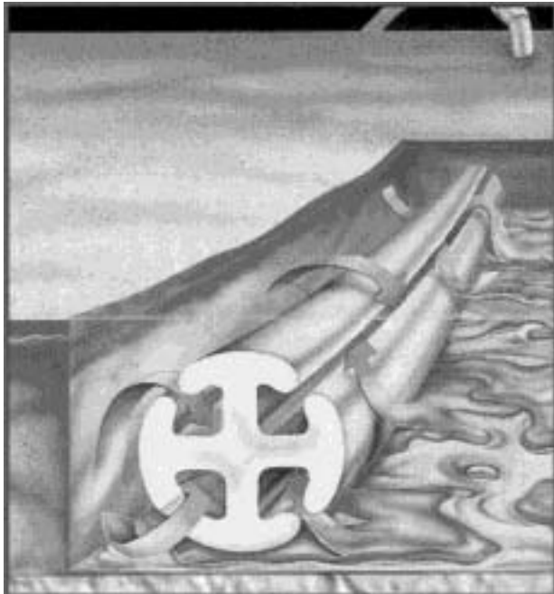
Fig. 1. Diseño acanalado de un drenaje Blake®. Cedida por Johnsons & Johnsons.
