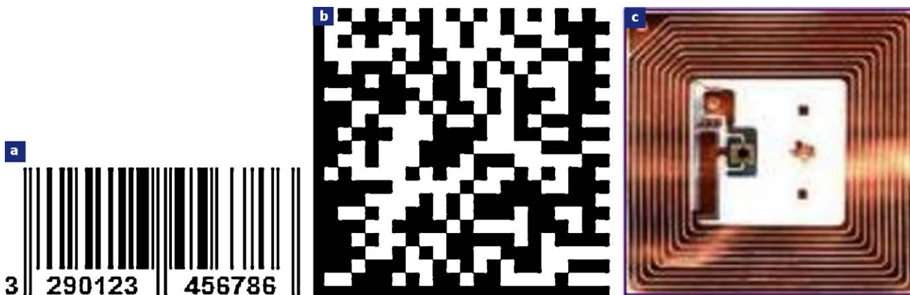
Figure 4. Différents type de symbolisation : a : code à barres unidimensionnel 1D ; b : code-barres bidimensionnel 2D Datamatrix ; c : code à barres avec système RFID. A set of symbolization: a: unidimensional bar code 1D; b: two-dimensional bar code 2D Datamatrix; c: bar code with RFID system.
